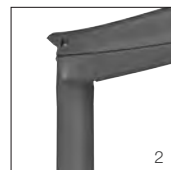
Aufsatzbefestigung einsteckend für Ausleger aus Stahl oder Aluminium
